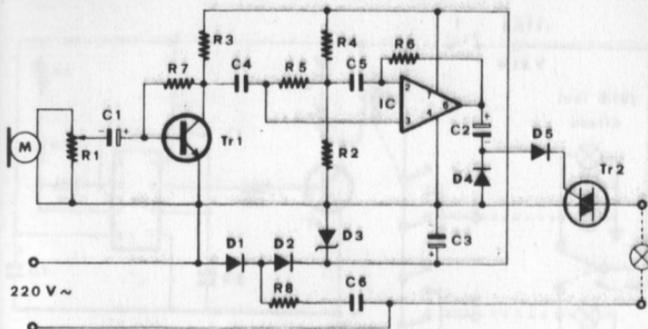
Con il Kit RS 53 si realizza un ottimo impianto di luci psichedeliche senza effettuare collegamenti alle casse acustiche. Il suono viene ricevuto dal microfono e, dopo una adeguata amplificazione e rettificazione viene inviato a pilotare un Triac il quale può provvedere a far accendere e spegnere una o più lampade al ritmo della musica. Con il potenziometro R1 si regola la sensibilità.
